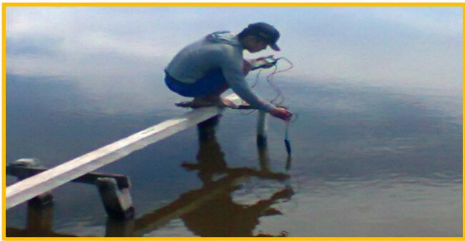
Gambar 14. Pengukuran Oksigen Terlarut pada Tambak di Kec Balinggi Kab Parimo
