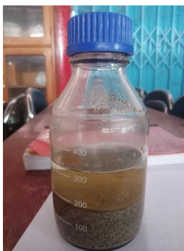
Gambar 4.7 Hasil pengujian kotoran organik pada agregat halus
