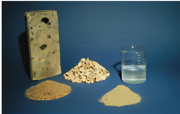
Gambar 2.1 Bahan Penyusun Beton Sumber : (Kosmatka dkk., 2002)
