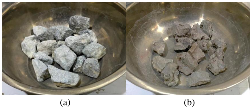
Gambar 4.1 Bentuk Agregat Kasar Konvensional (a) dan Slag Nikel (b)
