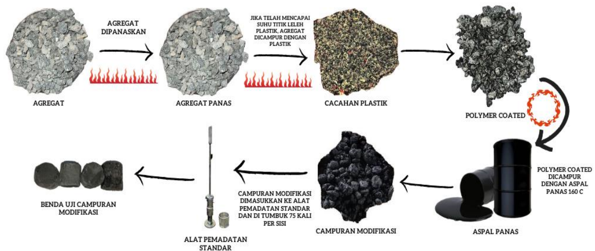
Gambar 3.5 Proses Pembuatan Benda Uji dengan Penambahan Plastik Metode Kering
