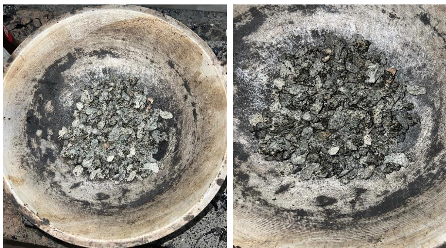
Gambar 4.7 Hasil penyelimutan agregat kasar dengan plastik LDPE 2%
