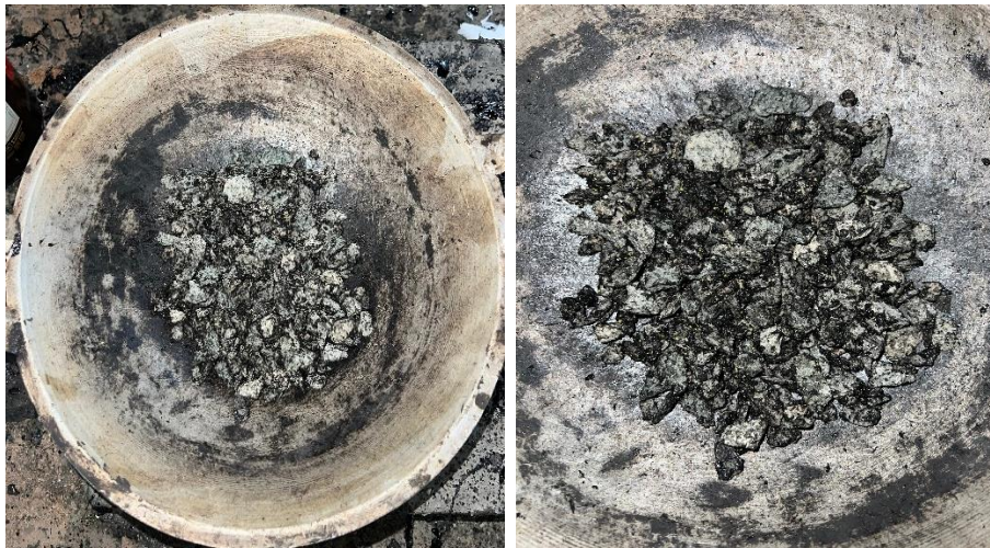
Gambar 4.8 Hasil penyalimutan agregat kasar dengan plastik LDPE 3%
