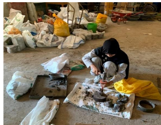
Pengujian Analisa Saringan
