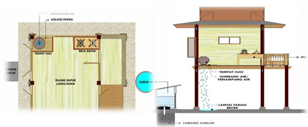
**Gambar : 5.21 Sistem pembuangan air kotor zaman dulu.**
