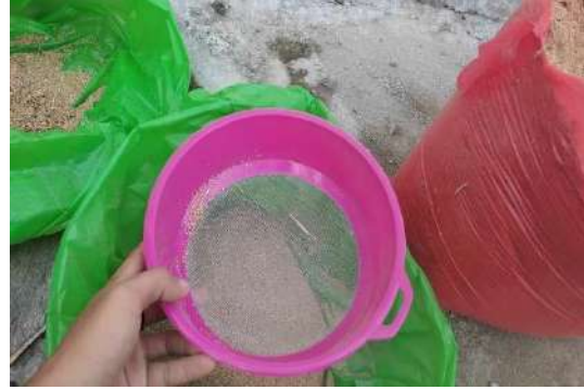
Gambar 2. Penyaringan Manual Serbuk Kayu
