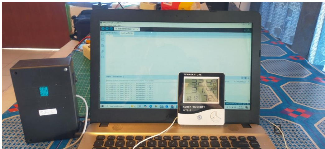
Gambar 4. 10 sensor DHT11 dan alat ukur digital HTC-2 untuk suhu
