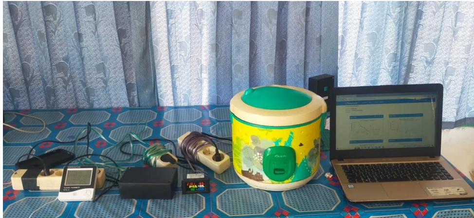
Gambar 4. 12 Pengujian PZEM004T dan alat ukur digital kWh meter D96-2049
