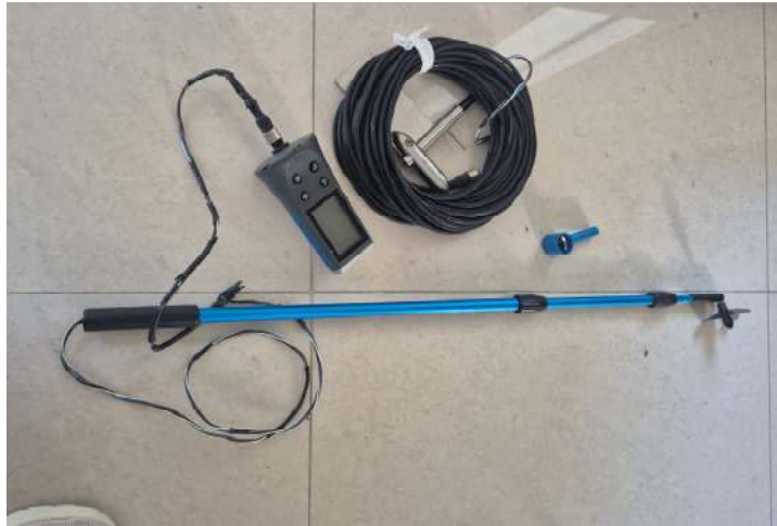
Gambar 2.8 Alat Pengukur Kecepatan ( Current Meter )
